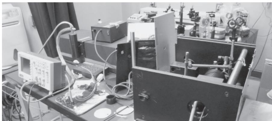
薄膜の過渡吸収測定装置
