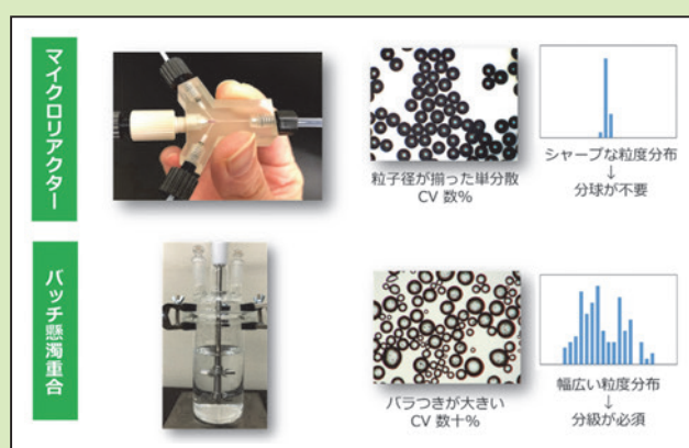
図1 マイクロリアクターを用いた粒子径の揃った高分子粒子作製の事例
