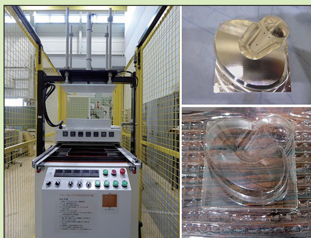
図4 真空成形事例 （左：真空成形機、右上：成形型／右下：成形品）
