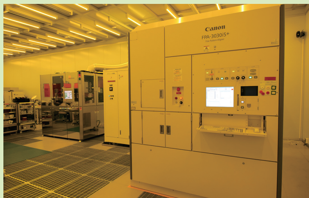
図1. 試作コインランドリの一部（i線ステッパとコータデベロッパ）
