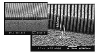
図 2 : ナノインプリントによる PMMA の高アスペクト比 ナノ構造の作製例
