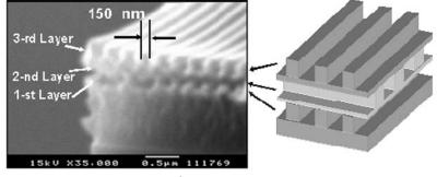
図4:リバーサルナノインプリントによる三次元積層構造の作製例 フォトニック結晶やナノバイオ素子への応用が期待されます.
