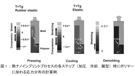
応力集中による欠陥発生メカニズムを理解,回避するために有効です.
