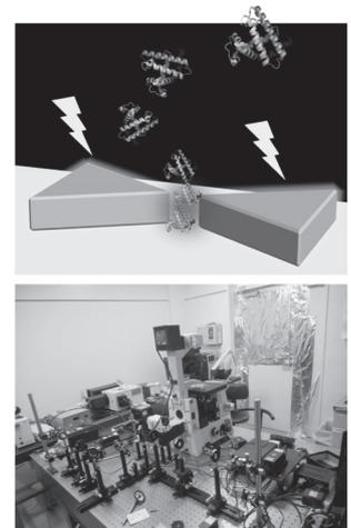
図4.（上段）プラズモン光ピンセットの概念図（下段）高空間分解能蛍光・ラマン顕微鏡
