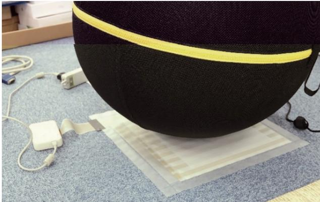
図3 圧力センサシートとバランスボール
